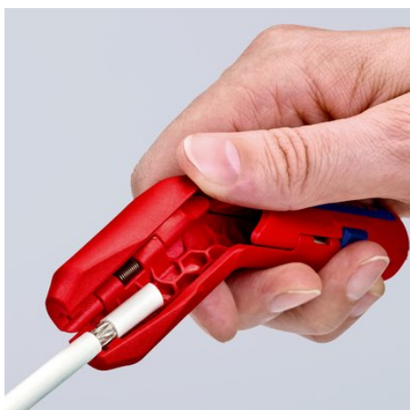
Afstripten van een coax-kabel
