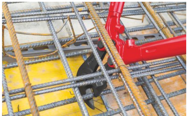
Betoniverkko-/rautaleikkurin 71 82 950 erityinen pään muoto mahdollistaa latteiden rakennusterästen leikkaamisen
