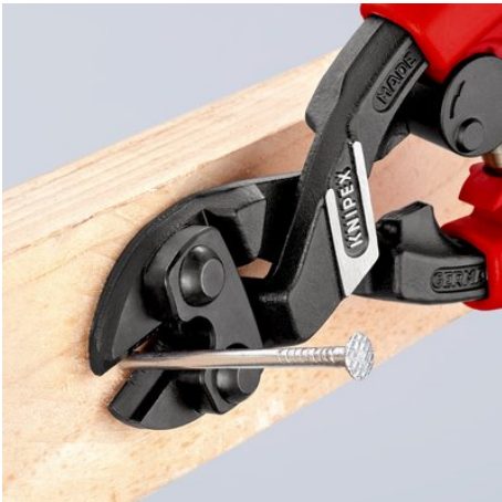
Λυγισμένη κατά 20° κεφαλή με μονόπλευρη γλώσσα και πλάγια κοπή για ισόπεδο κόψιμο, με ελεύθερο χώρο για πιάσιμο
