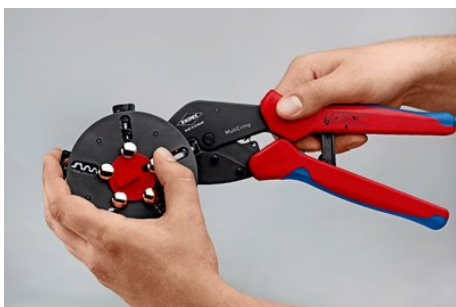
Výměna krimpovacího nástavce: Odaretuje polohu zásobníku, sejměte krimpovací nástavec z kleští.
