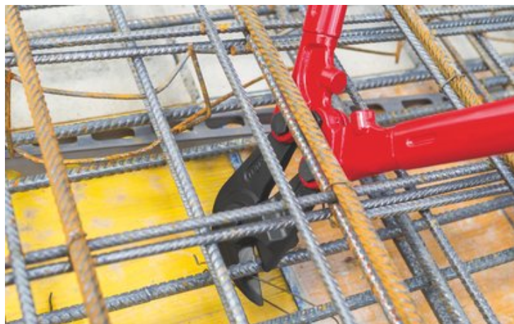
Zvláštní tvar hlavy pákových kleští na pletivo 71 82 950 umožňuje řezání ploché konstrukční oceli
