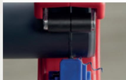
最短 10mm のセグメントを切断。スパイラルチップは面取りによって生じたものです。
