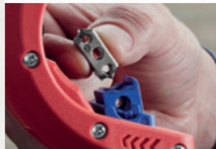
摩耗した場合は工具なしでブレードを逆さに入れ替え、交換できます。
