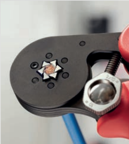
Τεράστια δυνατότητα: πρεσάρισμα μυτών ακροχιτωνίων έως 16 mm 2 και διπλών μυτών ακροχιτωνίων έως 2 x 10 mm 2 .
