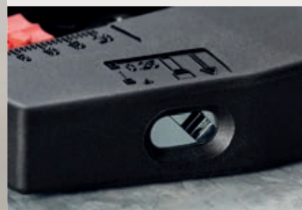
Μήτρα πρεσαρίσματος για τετράγωνο «πάτημα» σε μύτες ακροχιτωνίων 0,25 – 4 mm 2 .
