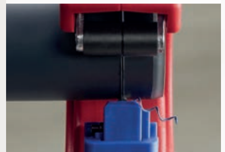
Μπορούν να κοπούν μικρά τμήματα έως και 10 mm. Το στεπειροειδές γρέζι δημιουργείται από το φρεζάρισμα.
