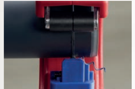
Lyhin leikattava pituus 10 mm. Viisteityksessä muodostuu spiraalilastua.
