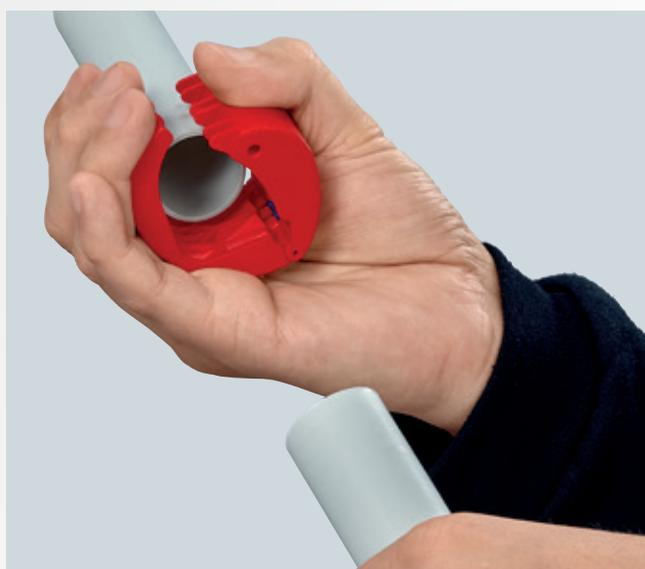
Práctico, rápido y limpio: los tubos de plástico se pueden cortar en muy poco tiempo y las secciones se sujetan con seguridad en la herramienta.
