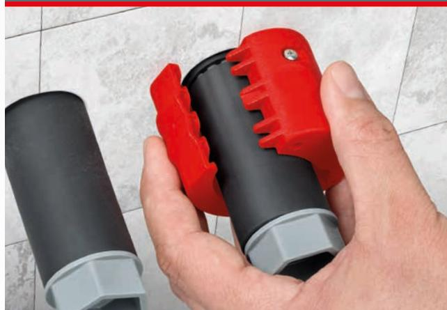
Уникальная конструкция поворотного блока лезвия означает, что водоотводящие и уплотнительные втулки можно надежно отрезать на расстоянии 2-3 мм от стены для безопасного отвода влаги.
