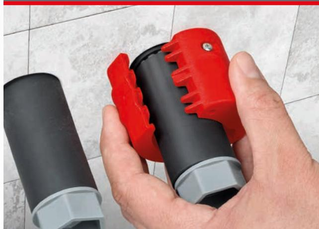
L'esclusiva struttura del blocco lame rotante permette di tagliare in modo affidabile i manicotti antigoccia e di tenuta da 2 a 3 mm davanti al muro per drenare in modo affidabile l'umidità.
