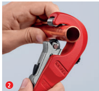
2 한 손 방식의 신속 조절 및 잠금 기능으로 커팅 휠을 밀어 올려서 빠르게 다양한 파이프 직경에 대한 조절이 가능합니다.
