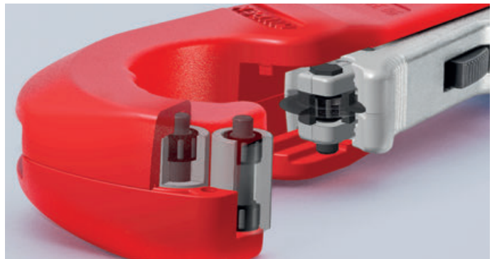
고품질의 니들 베어링 덕분에 커팅 휠과 네 개의 가이드 롤러가 절단 시 마찰 없이 작동하며 특히 스테인리스강 파이프를 쉽게 절단할 수 있습니다.
