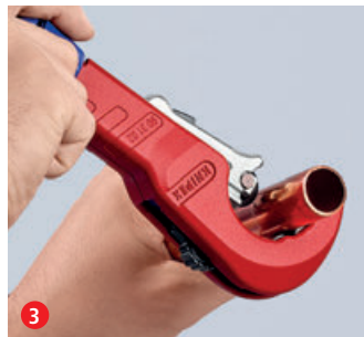
3 빠르게 비틀어 조이고 절단한 다음 인체공학 적 설계된 파란색 손잡이를 사용하여 재설정합니다.
