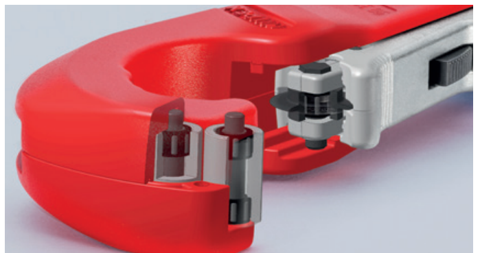
高品質のニードルベアリングにより、切断時の切断ホイールと4つのガイドローラーの 摩擦を軽減、ステンレスパイプを簡単に切断
