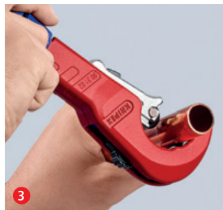
締め付けてから素早く回し、 青の送りハンドルで再調整します
