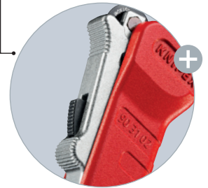
片手操作のクイック調整機能により スプリング荷重のかかった切断ホイールを 押し上げてパイプの直径に固定
