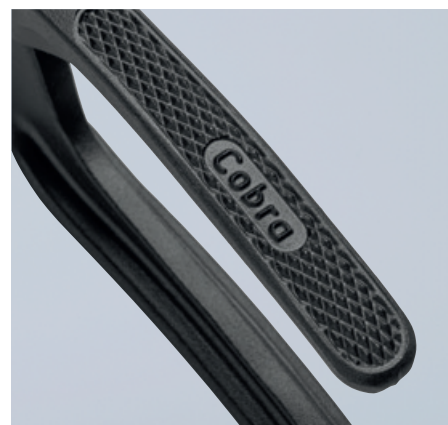
サイズを可能な限り小さくするため、ハンドルはコーティングされていません。高い掴み能力を発揮するため、外側はエンボス加工が施されています。
