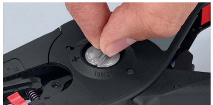
被覆の硬さ・軟らかさが変化するような様々な特殊条件下では、調整ダイヤルで最適な掴み能力へ微調整ができます。
