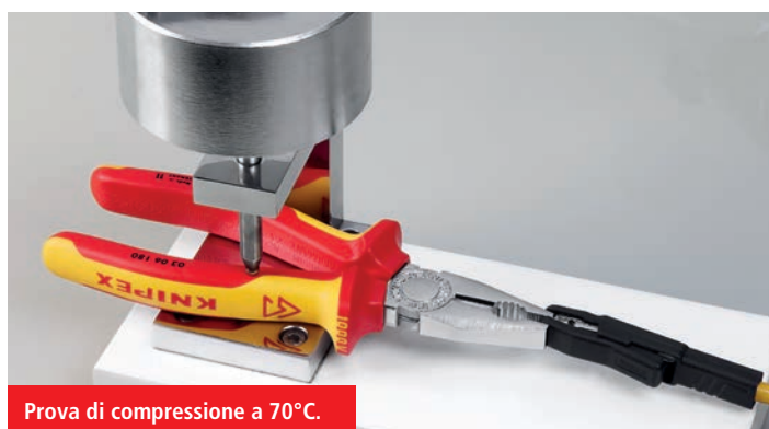
Prova di aderenza delle guaine con rivestimento isolante VDE con una forza di 500 N a 70°
