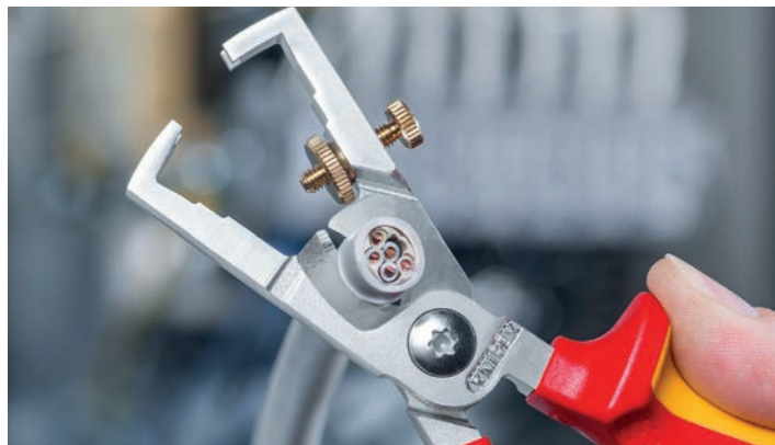
Contrassegno lunghezza: i contrassegni rappresentano un valido ausilio in caso di spelatura in serie nelle lunghezze più comuni (11 mm e 16 mm)
