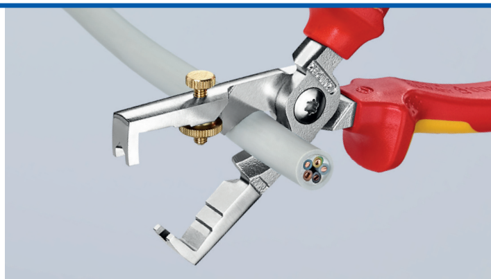
Tagliante temperato a induzione e rettificato di precisione per tagliare cavi di rame e di alluminio fino al Ø 15 mm (5 x 2,5 mm 2 ) senza rischio di schiacciamenti
