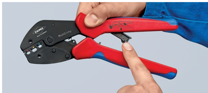
Sbloccare la leva di posizionamento e chiudere la pinza - pronta per l'uso
