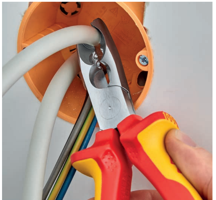
Tagliente circolare con limite di profondità: per una spelatura facile e senza danneggiamento
