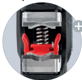
Le lame paraboliche separano dapprima l'isolamento, quindi lo estraggono automaticamente dalla parte posteriore
