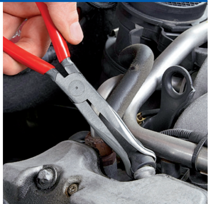
Schonendes Lösen von Schläuchen in schwer zugänglichen Bereichen.
