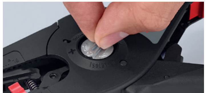
Bei vielen speziellen Anforderungen, etwa besonders harten oder weichen Isolationsmaterialien, erlaubt das Verstellrad mit fühlbaren Rastpositionen die optimale Feinjustierung
