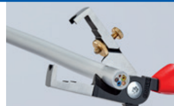
Induktiv gehärtete Scherschneide mit Präzisionsschliff zum quetschfreien Schneiden von Kupferkabeln bis Ø 15 mm (5 x 2,5 mm 2 )
