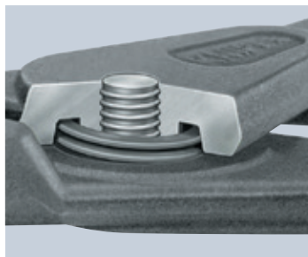
Innenliegende Feder: Geschützte Lage im geschraubten Präzisionsgelenk. Keine Behinderung bei der Arbeit, keine Verschmutzung oder Verlust
