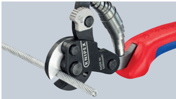
Schneiden von hochfesten Drahtseilen (1960 N/mm 2 ) bis Ø 4 mm
