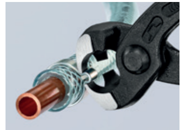
10 99 I220: Abdichten Fluidschlauch an Stutzen mittels Seiten-Pressnase
