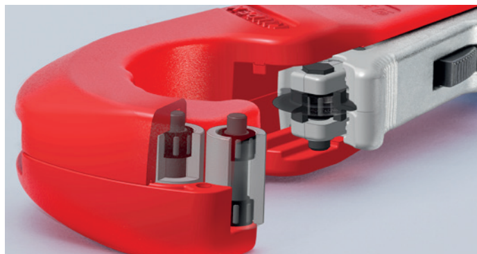
Krążek tnący i cztery roleki prowadzące pracują praktycznie bez tarcia podczas cięcia dzięki wysokiej jakości łożyskom igielkowym - wyjątkowo łatwe cięcie rur ze stali nierdzewnej
