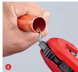
4 Gotowe! W razie potrzeby możliwe jest wygładzenie powstałej w wyniku przecięcia krawędzi za pomocą rozkładanego gratownika i to przy zaskakująco niedużym wysiłku.
