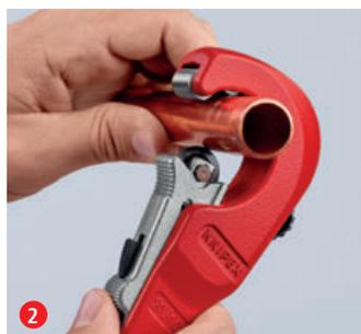
2 Empurrando o disco de corte contra o tubo com fixação rápida com uma mão QuickLock: ajuste mais rápido para diferentes diâmetros de tubo ...
