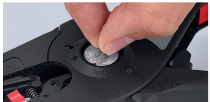
Para requisitos especiais, como materiais de isolamento especialmente duros ou macios, podem ser feitos ajustes precisos ideais usando a roda de ajuste com as respectivas posições de travamento táteis
