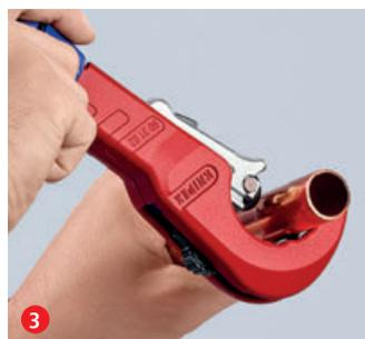
3 Corte com um giro rápido e, em seguida, reajuste usando o botão ergonômico giratório azul ...
