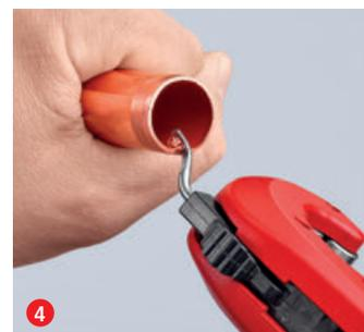
4 E pronto! Se necessário, alise a borda do corte suavemente usando a ferramenta de rebarbação desdobrável - com esforço surpreendentemente pequeno
