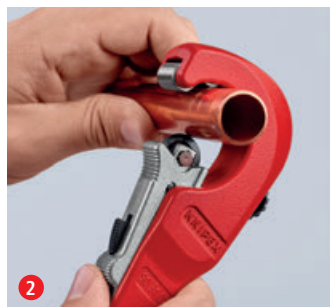
2 Snijwiel met éénhands QuickLock-snelverstelling op de pijp schuiven: snel af te stellen op verschillende pijpdiameters ...
