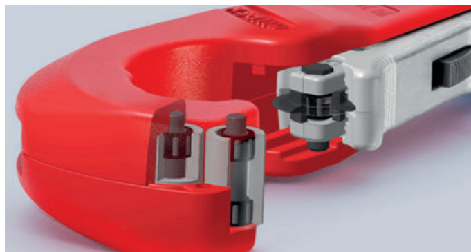
Het snijwiel en de vier geleiderollen draaien bij het snijden praktisch zonder storende wrijving dankzij de hoogwaardige nagelagers
