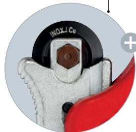
Het gehard stalen snijwiel draait op naaldlagers en is eenvoudig te vervangen
