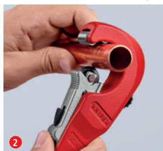
2 Poussez la molette de coupe contre le tube avec le système QuickLock à verrouillage en butée rapide d'une seule main : le réglage le plus rapide pour différents diamètres de tubes ...
