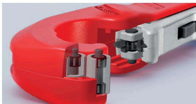
Des roulements à aiguilles de haute qualité permettent à la molette de coupe et aux quatre rouleaux de guidage de fonctionner pratiquement sans frottement gênant pendant la coupe – coupe les tubes en acier inoxydable avec une facilité extraordinaire
