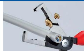
Cisaille trempée par induction avec affûtage de précision pour la coupe sans coincement de câbles Cu et Al jusqu'à Ø 15 mm (5 x 2,5 mm<sup>2</sup>)
