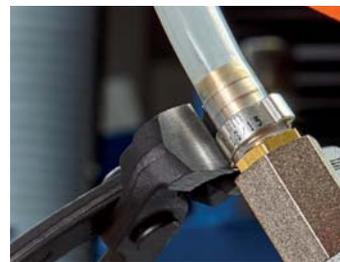
10 98 I220 : Étancher un raccord de tuyau au graissage central
