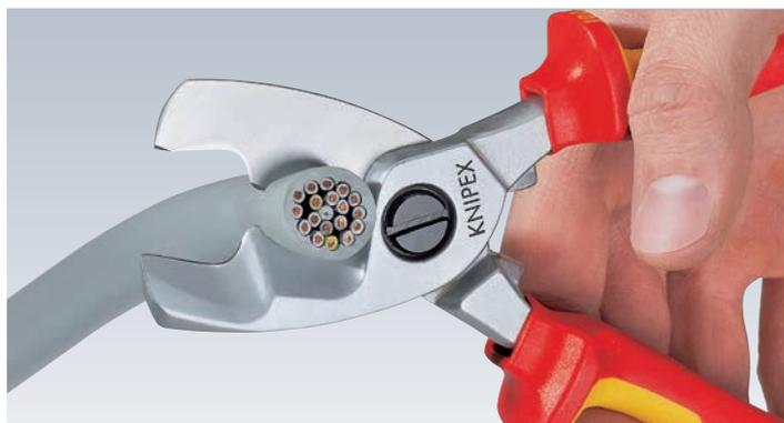
**Coupe définitive:** une fois la gaine du câble coupée dans le profil avant, on coupe les conducteurs dans le profil arrière. Coupe préliminaire à l'avant, coupe définitive à l'arrière – la coupe est plus facile.
