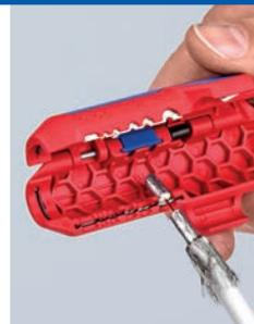
Dénudage d'un câble coaxial
