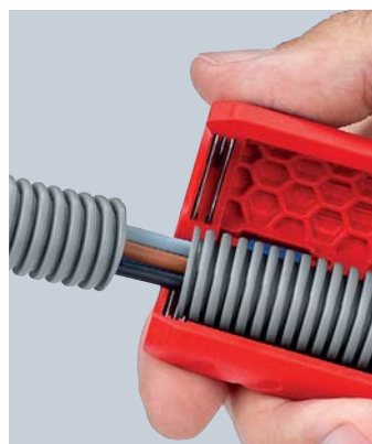
Bordo di taglio pulito e nessun danno ai cavi posti all'interno, grazie al taglio eseguito sempre sopra l'ondulazione
