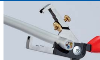
Tagliente temperato a induzione e rettificato di precisione per tagliare cavi di rame fino al Ø 15 mm (5 x 2,5 mm 2 ) senza rischio di schiacciamenti
