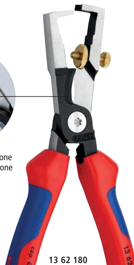
Tagliente temperato a induzione e rettificato di precisione per tagliare cavi di rame fino al Ø 15 mm (5 x 2,5 mm 2 ) senza rischio di schiacciamenti
