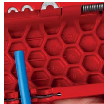
90 22 02 SB: Scala di lunghezza stampata a iniezione per una spelatura uniforme alla stessa lunghezza, leggibile per destrimano e mancini
