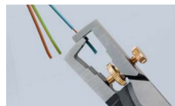
Contrassegno lunghezza: i contrassegni rappresentano un valido ausilio in caso di spelatura in serie nelle lunghezze più comuni (11 mm e 16 mm)
