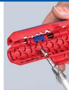
Dégainage d'un câble coaxial
