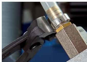
10 98 I220 : Étancher un raccord de tuyau au graissage central
