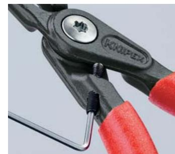
48 31 J1/J2, 49 31 A1/A2 : avec protection contre la distension (réglable par butée), aucune déformation excessive de petits circlips pour alésage
