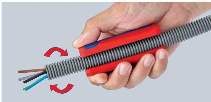
Manipulation simple : appuyer sur le KNIPEX TwistCut, tourner en effectuant une légère pression, c'est terminé
