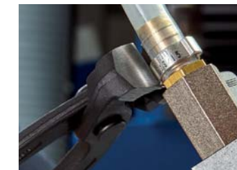
10 98 I220: Cierre estanco de conexiones con tubos flexibles en sistemas de lubricación central
