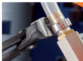
10 98 I220: Tätning slanganslutning mot centralsmörjningen
