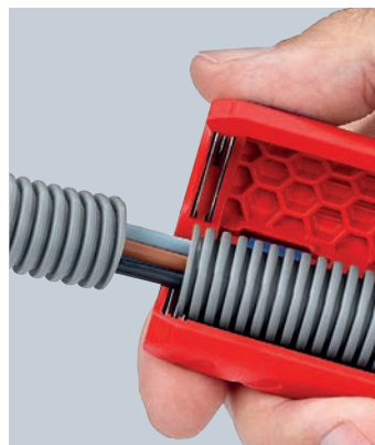
Perfekt snittkant och inga skador på de inneliggande kablarna, eftersom snittet alltid utförs i det korrugerade rörets periferi
