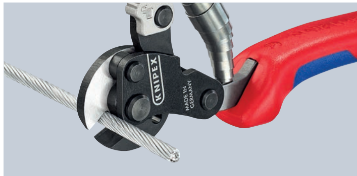
Kapning av högfäst vajer (1960 N/mm 2 ) upp till Ø 4 mm
