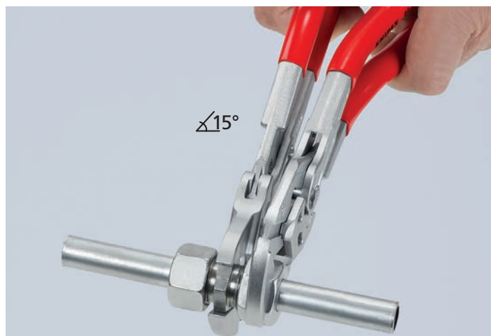
86 43 250: 15° vinklade tångskänklar ger utrymme där kontraskruv eller skruvförband i ytor kräver det; Minnskad risk för knogskador
