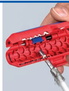
Avisolering av koaxialkabel
