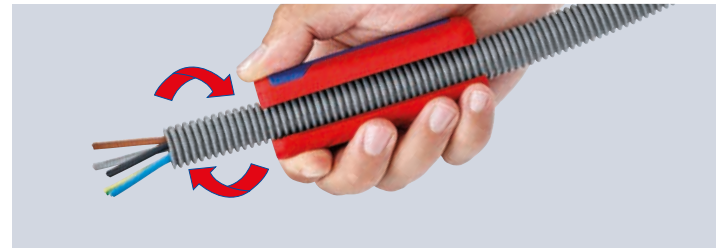
Yksinkertainen käsittellä: purista KNIPEX TwistCut kokoon, kierrä kevyesti painaen, valmis
