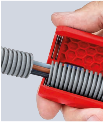
Puhdas leikkureuna, ei vaurioida sisäpuolisia johtoja, koska leikkaus on tapahtuu ylhäällä akselilla
