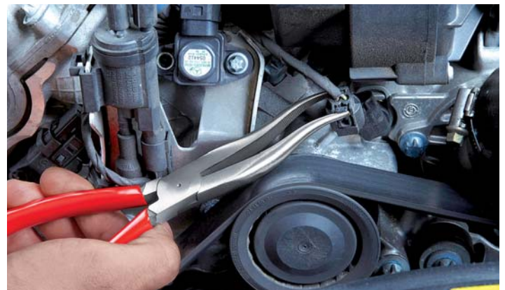
Allentamento sicuro dei tubi flessibili in punti difficilmente accessibili.
