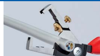
Tagliente temperato a induzione e rettificato di precisione per tagliare cavi di rame fino al Ø 15 mm (5 x 2,5 mm 2 ) senza rischio di schiacciamenti
