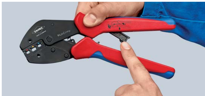
Sbloccare la leva di posizionamento e chiudere la pinza - pronta per l'uso
