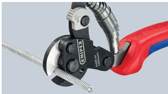
Taglia funi metalliche ad alta resistenza (1960 N/mm 2 ) fino al Ø 4 mm
