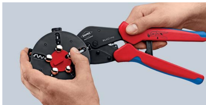
Udskiftning af crimpindsatser: Magasinpositionen låses op, crimpindsatsen i tangen tages ud
