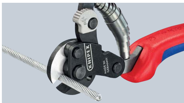
Skæring af ekstra faste stålwirer (1960 N/mm 2 ) op til Ø 4 mm
