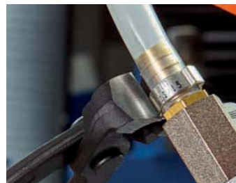
10 98 I220: Cierre estanco de conexiones con tubos flexibles en sistemas de lubricación central
