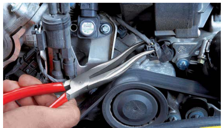
Aflojar cuidadosamente mangueras en zonas de difícil acceso
