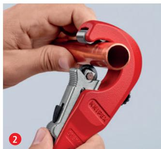
Disco di taglio con fissaggio rapido con una sola mano QuickLock spingere sul tubo - geniale il TubiX® rimane sempre maneggevole a lungo
