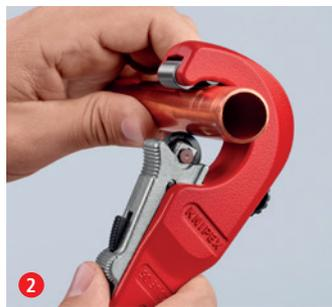
2 Empuje el disco de corte contra la tubería con la fijación rápida QuickLock con una sola mano: ajuste rápido para tuberías de diferentes diámetros ...
