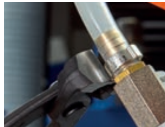
10 98 I220: Abdichten Schlauchanschluss an Zentralschmierung
