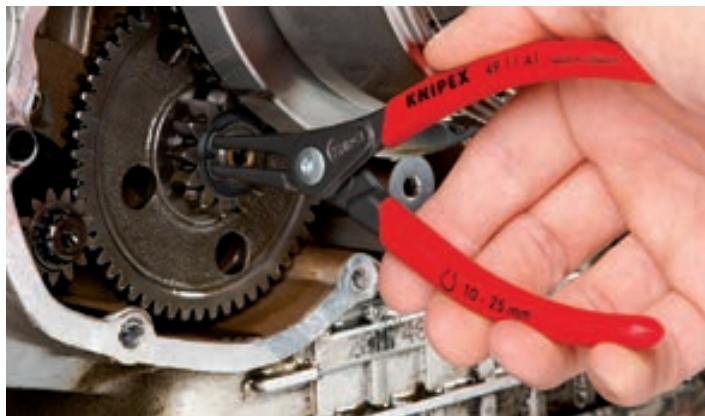
KNIPEX-Präzisions-Sicherungsringzange: verwindungsfreie, leichte und schnelle Montage des Rings
