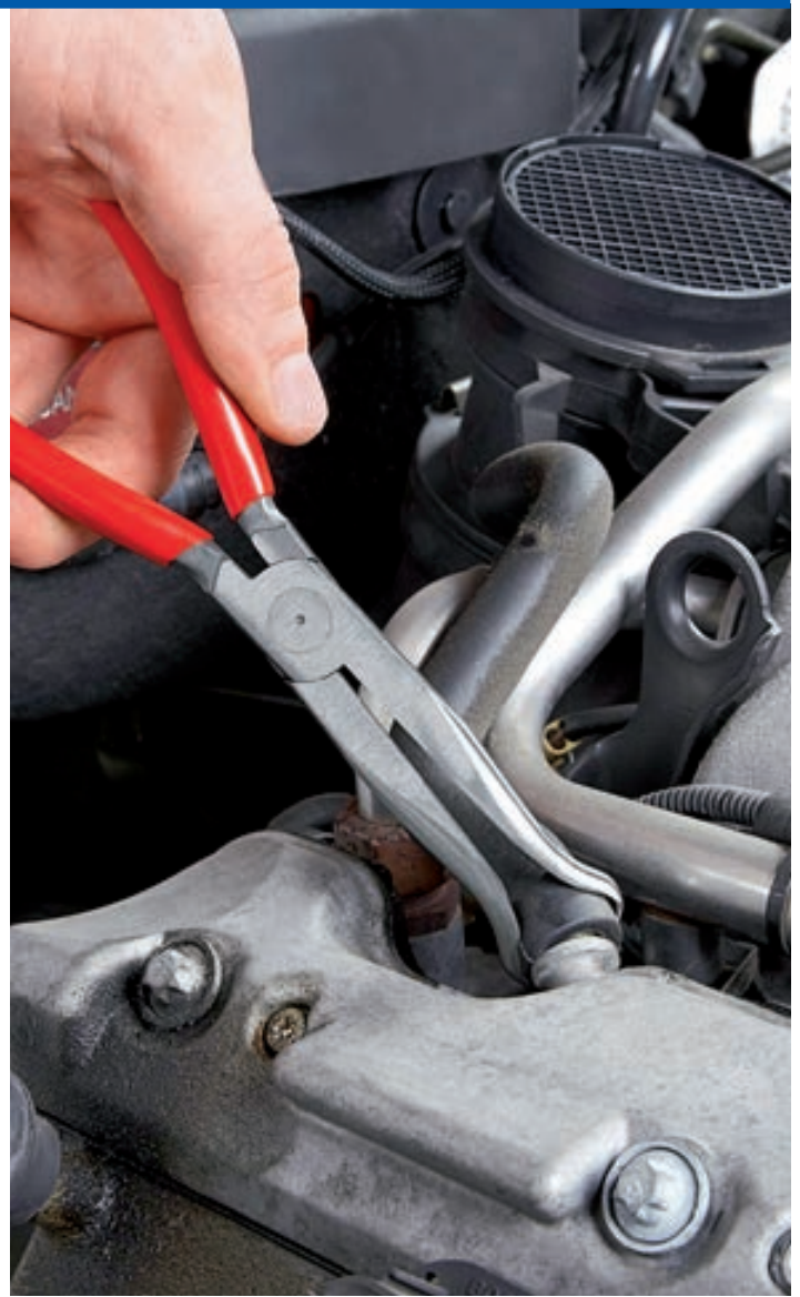
Schonendes Lösen von Schläuchen in schwer zugänglichen Bereichen.
