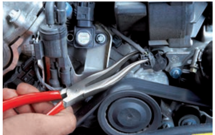
Schonendes Lösen von Schläuchen in schwer zugänglichen Bereichen.
