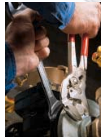
Durante el bloqueo de las tuercas, la tenaza llave se puede emplear como herramienta complementaria ideal
